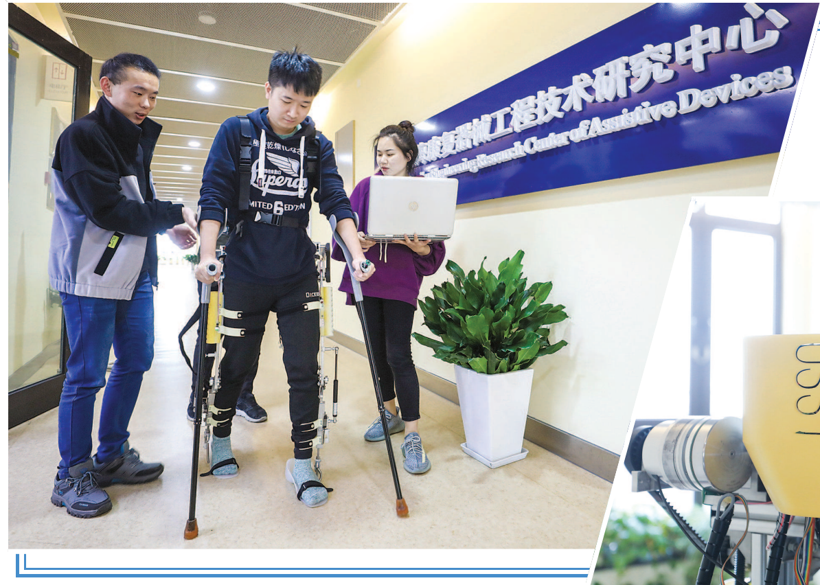
四方联合共建的“医疗器械创新与转化平台”,助力科研项目在产业化赛道上“加速”。图为上海理工大学康复器械工程技术研究中心的科研团队正在测试膝关节驱动下肢外骨骼康复机器人。
