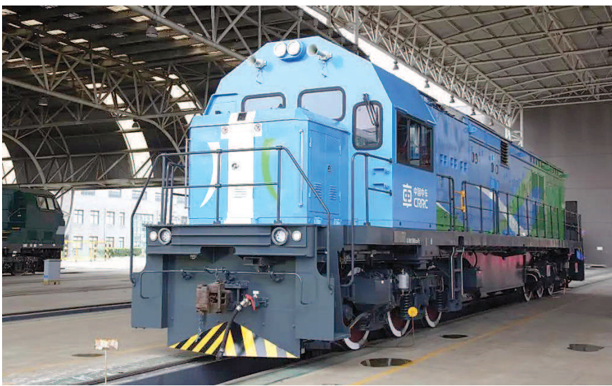
中国中车与同济大学联合研制国内最大功率氢燃料电池混合动力机车。
