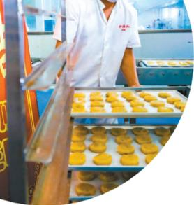
闵行区浦江镇,杏花楼的生产车间里正在连轴转。今年,这个生产车间完成了智能化升级,总共16道月饼制作工序中,98%已实现自动化生产,连刷蛋液的“精细活”也由机器包办了。“上了智能化设备后,人工减了三分之一,产能增加了,月饼季的大生产周期精准控制在50天。”杏花楼广式月饼制作技艺第五代传承人沈全华说。
