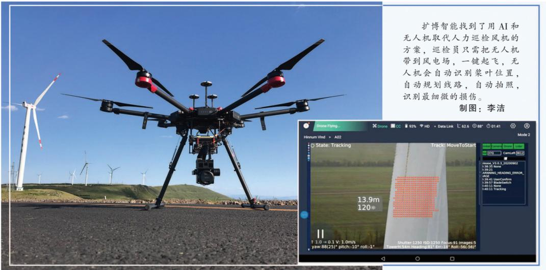
扩博智能找到了用AI和无人机取代人力巡检风机的方案,巡检员只需把无人机带到风电场,一键起飞,无人机会自动识别叶片位置,自动规划线路,自动拍照,识别最细微的损伤。
