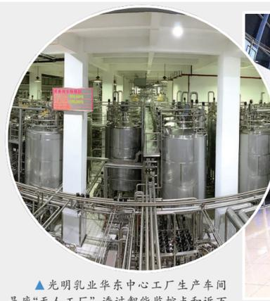
▲光明乳业华东中心工厂生产车间是座“无人工厂”,透过智能监控点和近万个阀门,数据代替人工“照看”生产流程。
