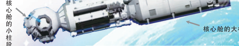
核心舱的大柱段直径4.2米,差不多有地铁车厢的1.5倍,主要是航天员工作和实验的地方;小柱段直径为2.8米,是航天员的睡眠区和卫生区,用于保障航天员的生活和正常居住。
