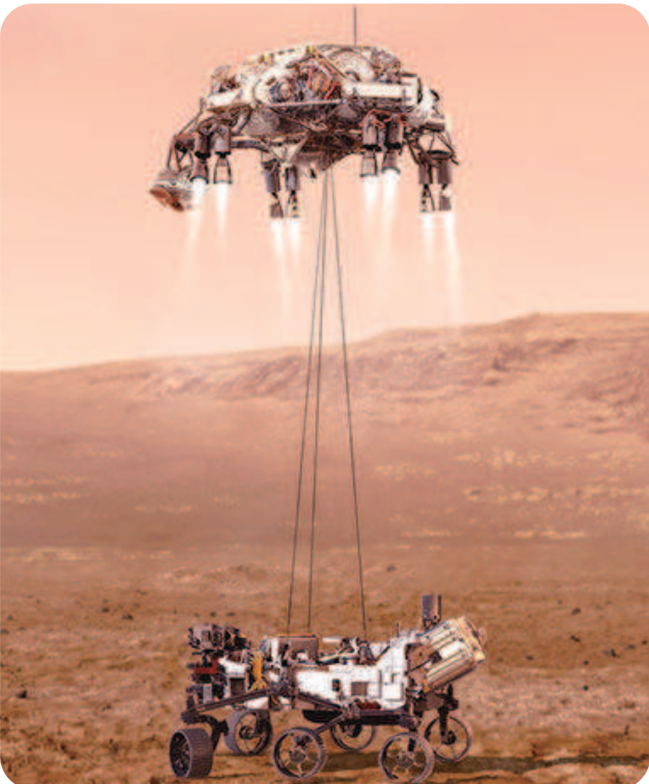
一个吊车式装置被设计用来将 NASA 漫游车吊运到火星上软着陆。图/NASA/JPL
