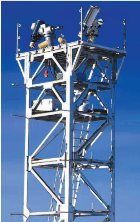
作为我国第二代望远镜，南极巡天望远镜AST3口径增大到50厘米，是南极目前最大的光学望远镜。马斌供图
