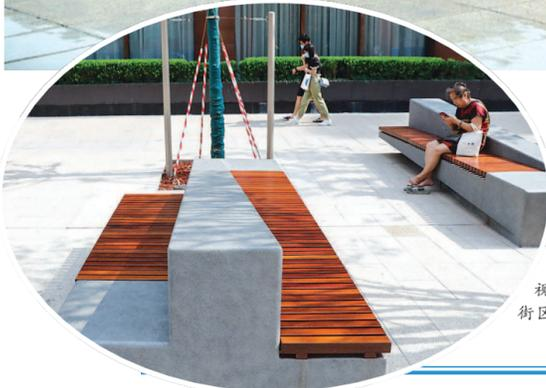
东拓段的景观座椅采用高分子聚酯材料,上面铺设了木质坐垫,天凉时坐上去也不会感觉冷。
