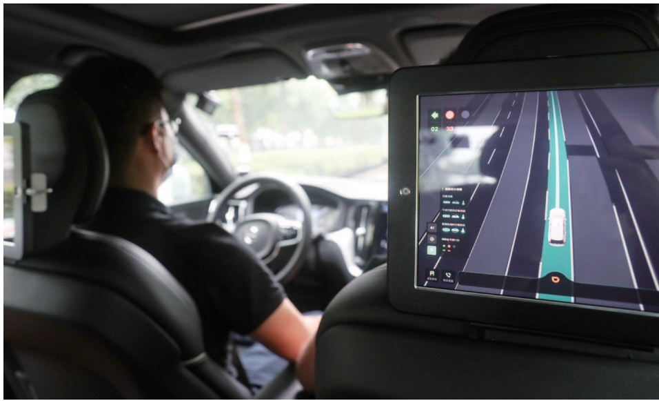
主驾驶座上的安全员在车辆行驶时将手放在方向盘旁，前排座椅背后的屏幕上实时显示行人、车辆等周边路况。新华社记者 丁丁摄
