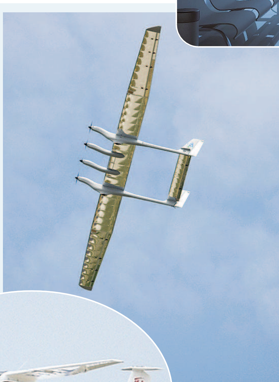
▲我国自主知识产权的中大型太阳能驱动“墨子II型”长航时飞机。
