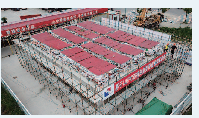
▲ 压载试验现场。 ▲ 利用新体系建造的示范楼。 ▲ 新体系的构件节点。(上海建工二建集团供图)
