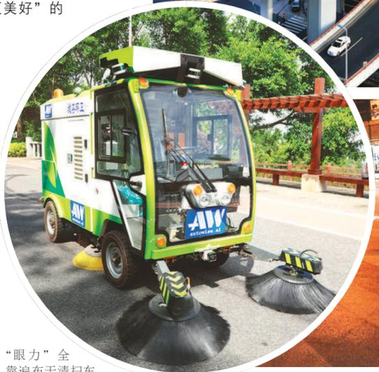
“眼力”全靠遍布于清扫车周身的各个传感器来实现。据了解，该车搭载了多个16线激光雷达和毫米波雷达、超声波雷达、摄像头等传感器，不仅能帮助其安全规避行人、车辆和各种障碍物，还能帮助它精准定位街面垃圾、定点扫除。
