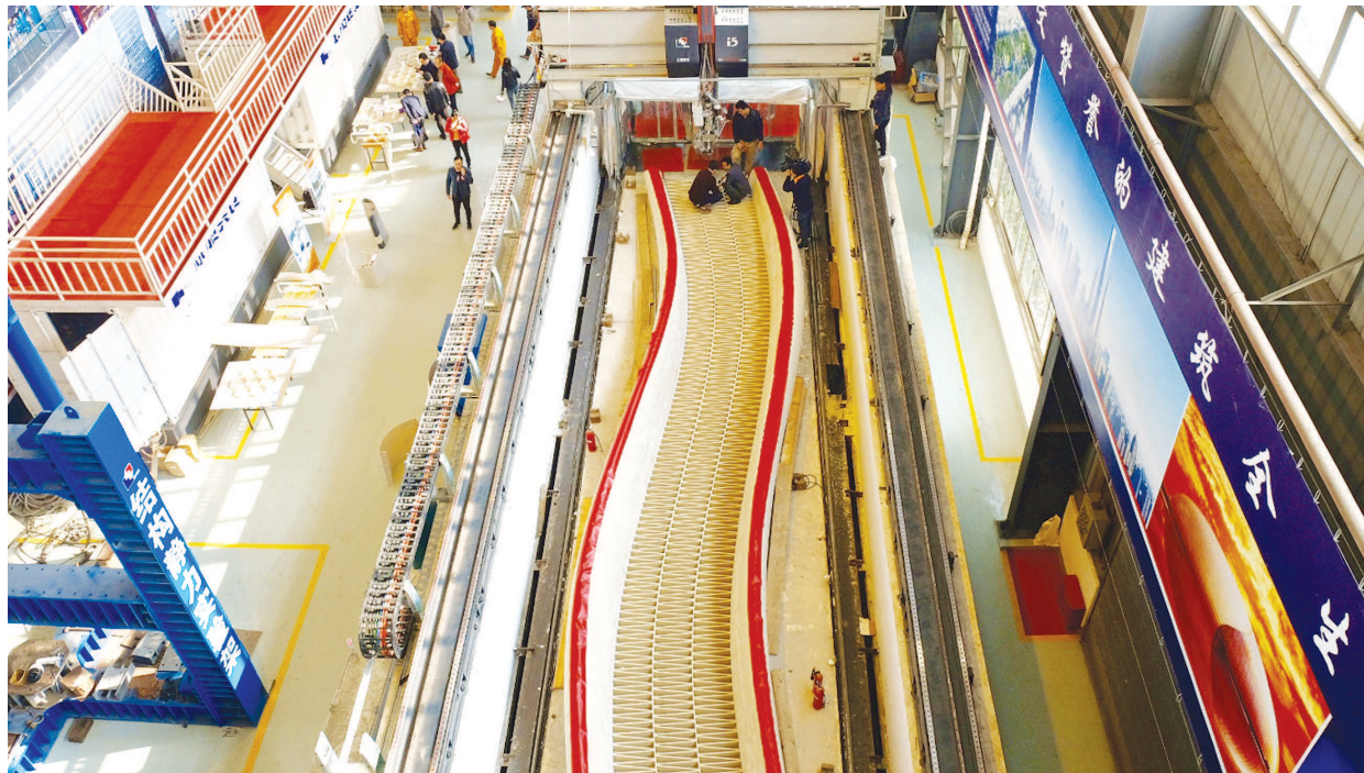
打印完毕的桥体陈列在上海建工集团数字三维建造中心。
