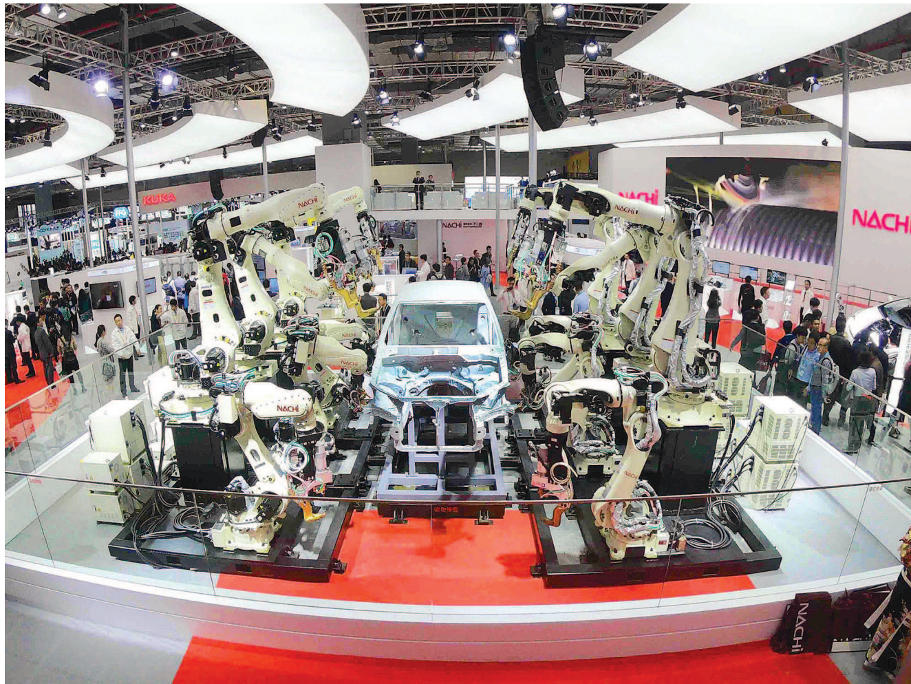
现场展出的机器人手臂焊接“无人车间”，近20台SRA机器人手臂各自分工同时进行汽车焊接作业。本报记者 赵立荣摄
