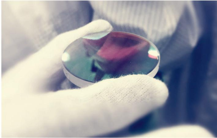
镀膜上的光学元件能引导激光奔向最终靶点。
