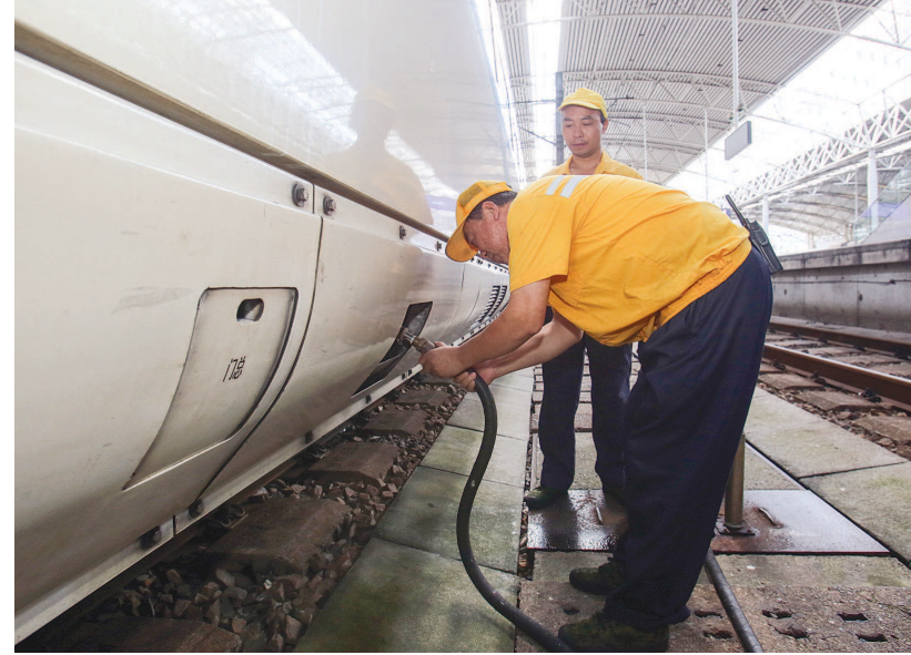
铁路上海站上水工刘明富正在给高铁列车上水。本报记者 叶展宸摄
