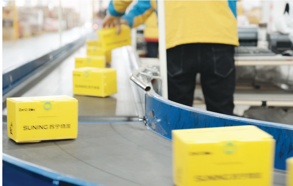
灰度环保自主研发的循环快递箱，外观、重量与纸箱很相似，都是由瓦楞板制成，只是材质从纸变成了PP（聚丙烯）。经过苏宁、京东等电商半年实测证明，哪怕循环使用40次，这种循环箱都看不出明显的损坏和划痕。借助独特的制造工艺以及专利锁扣技术，循环快递箱在使用时完全不用胶带。（灰度环保供图）
