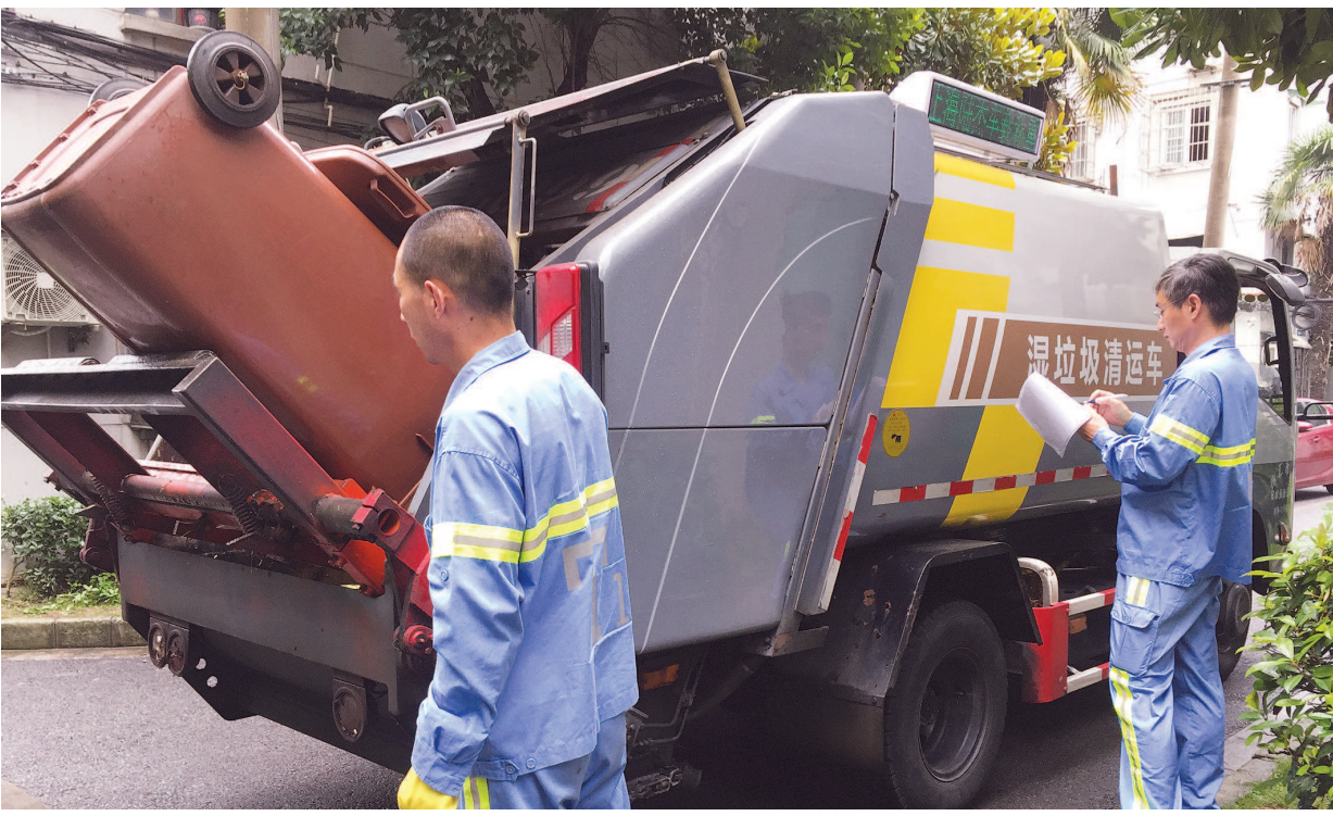
徐汇区在湿垃圾收运专用车辆上试点安装自动称重计量系统，车顶显示屏会呈现每桶湿垃圾的重量，供清运工人记录参考。
