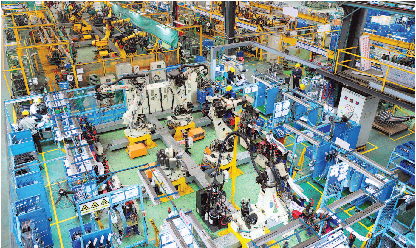
近年来,江苏省太仓市依托上海汽车产业的辐射效应,汽车零部件产业迅速发展壮大。图为在当地一家汽车配件公司的自动化焊接车间内,60多台工业机器人正在生产线上焊接汽车横梁。
